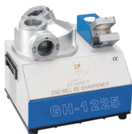
研磨範圍：4~13mm 端面角 6° 後斜角 20° 底溝角 30°
