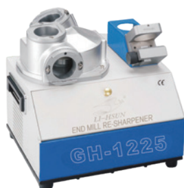
研磨範圍：12~25mm 端面角 6° 後斜角 20° 底溝角 30°
